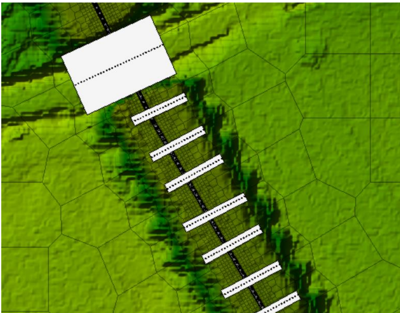
Figura 5 Esempio di struttura trasversale in area 2D, non compresa quindi nel dominio monodimensionale
