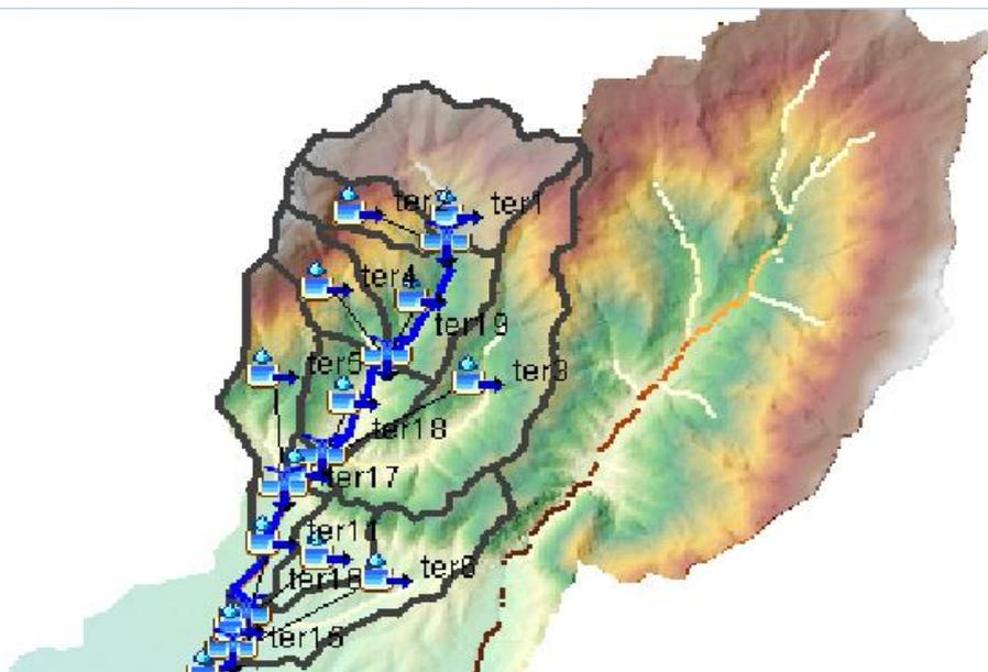
Figura 1 Ritaglio sottobacini e flood routing in Hec-Hms
